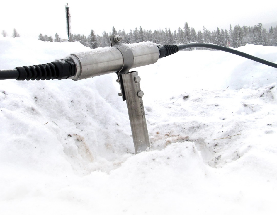
Опытный испытательный полигон. Закрепление электрода.
