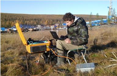
Электротомографический мониторинг позволяет получать информацию об изменениях в строении и свойствах грунтовых массивов, вызванных природными и антропогенными факторами.
